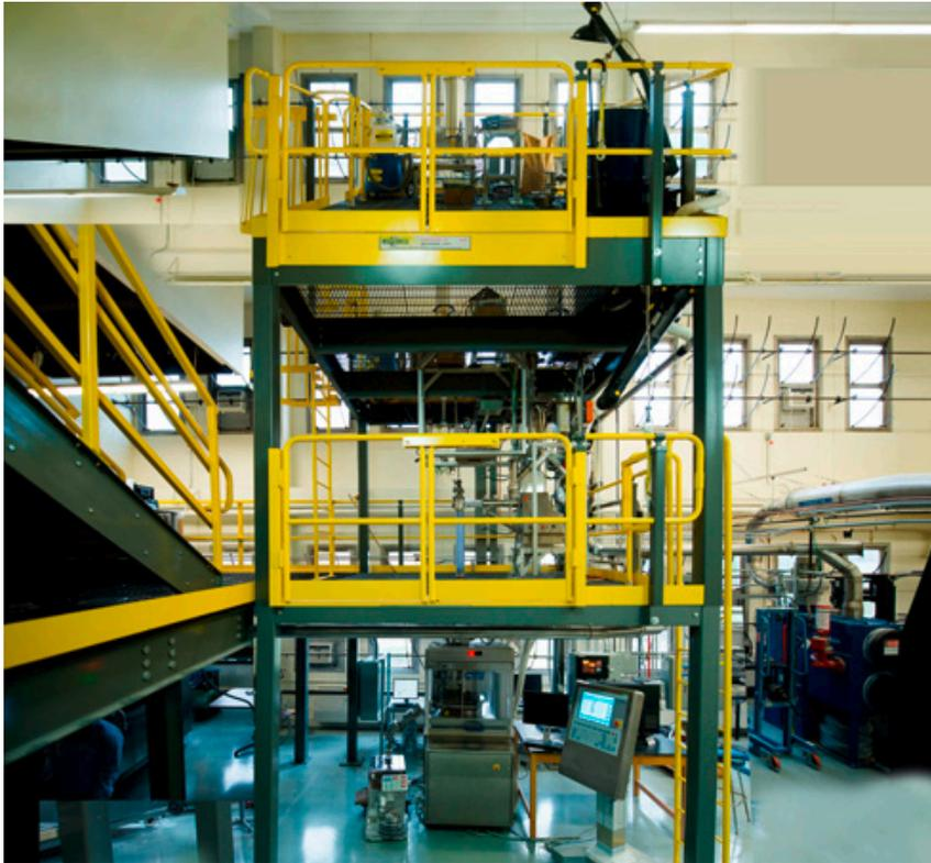
Abb. 3 Kontinuierliche Fertigungsanlage mit den Zuführbehältern für Wirkstoff und Hilfsstoffe sowie den Wägeeinheiten auf der obersten Etage.
