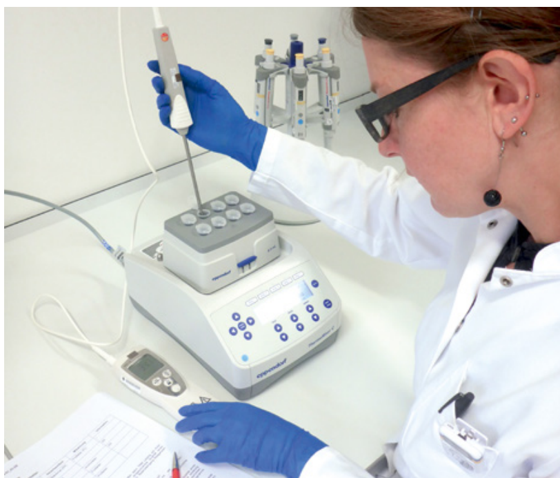
Abb. 3 Qualifizierung eines Thermocyclers. Unter GLP genutzte Geräte müssen kalibriert bzw. qualifiziert werden.
