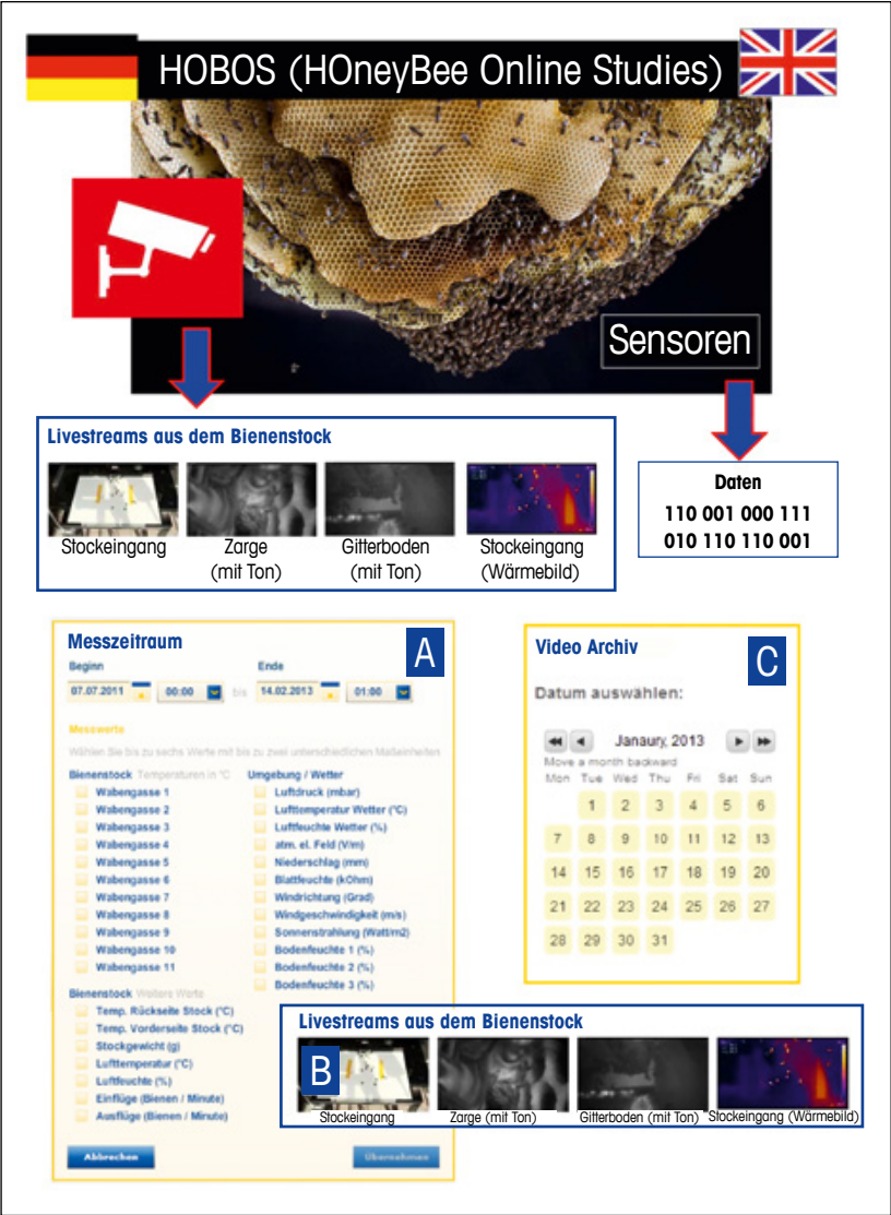
Abb. 3 Der große HOBOS-Lauschangriff auf ein intaktes Bienenvolk. Unterschiedlichste Videotechniken und eine große Anzahl an Sensoren liefern kontinuierlich Beobachtungsmöglichkeiten und Messungen aus einem ungestörten Bienenvolk.
