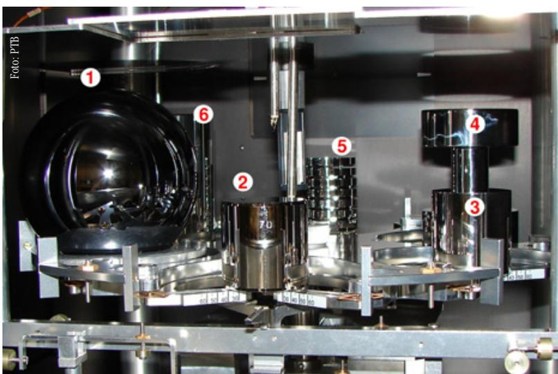
**Abb. 2** Blick in den Wägeraum während der Massebestimmung der  $^{28}\text{Si}$ -Kugel AVO28-S8 (1) mit Kilogrammprototyp Nr. 70 (2), Platin-Iridium-Sorptionskörpern (3, 5) sowie Auftriebskörpern zur Bestimmung der Luftdichte (4, 6)
