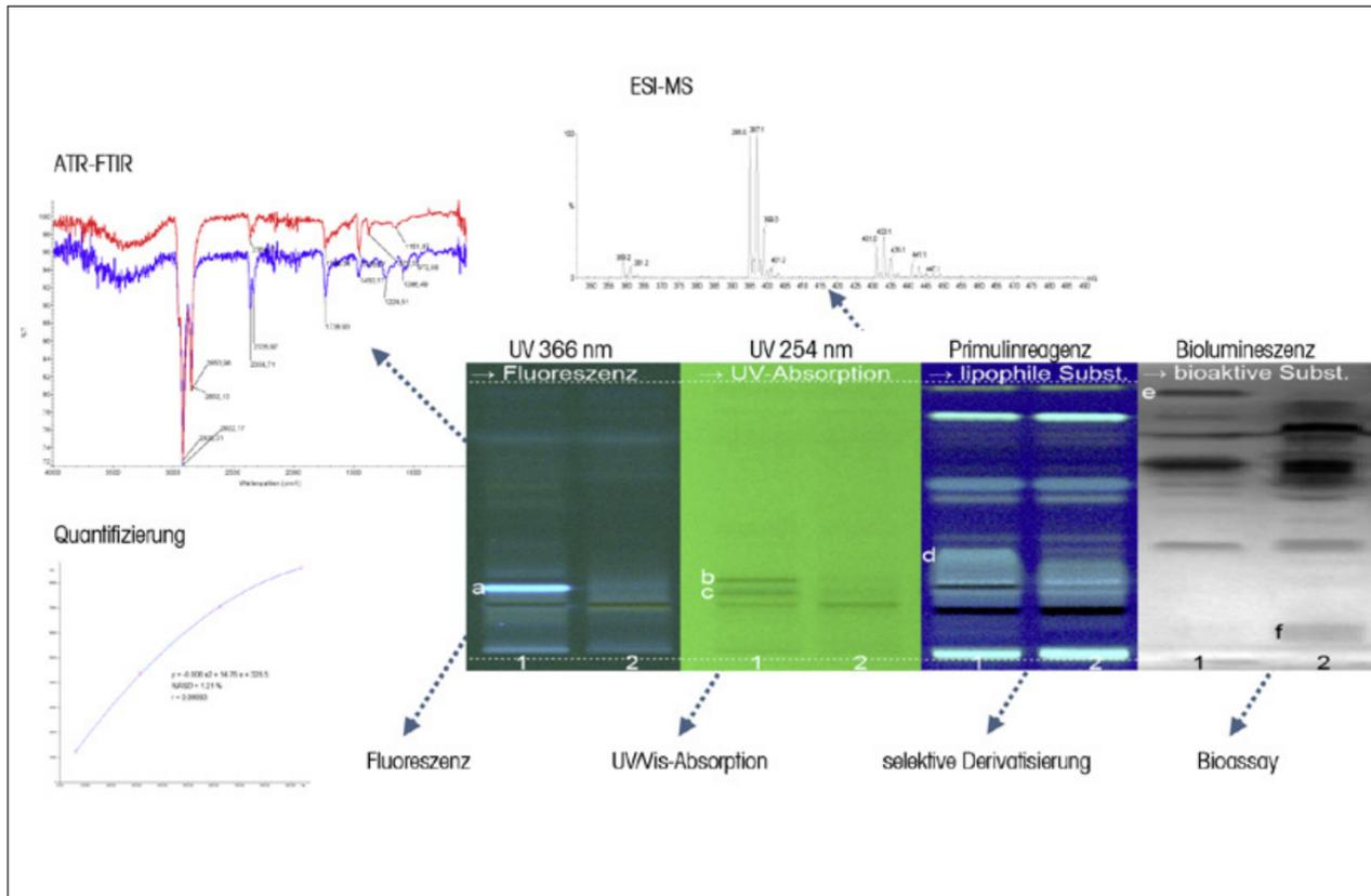
Abb. 1 Schnelle Charakterisierung zweier Proben (Bahn 1/2: nicht wirkend/wirkend) durch multiple Detektionsmöglichkeiten: Unterschiedliche Zonen a-f sind direkt erkennbar.
