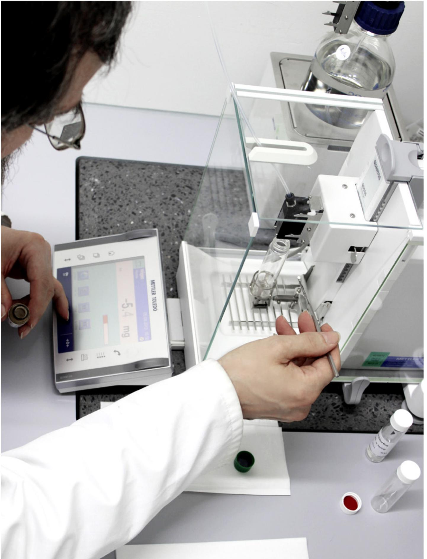
Probenvorbereitung mit dem Quantos QA-System. Die Rohsubstanz für die Stammlösung wird von Hand eingewogen, anschließend erstellt Quantos automatisch über das Liquidmodul automatisch die richtige Konzentration.
