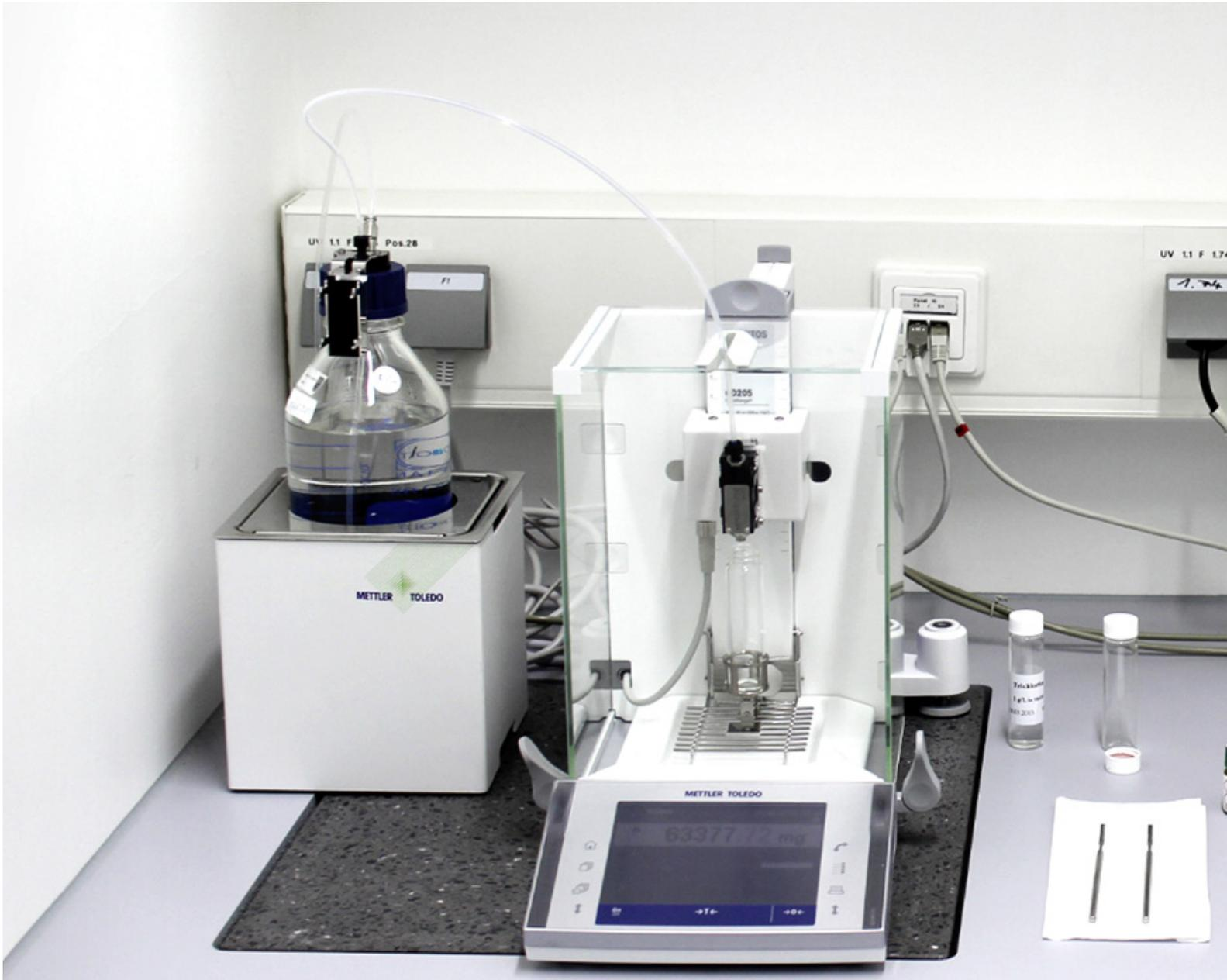
Das Quantos QA System, WorkflowBox und Label Printer. Die integrierte Lösung stellt automatisch die Substanzdatenbank mit Rohsubstanzen und Lösemitteln direkt auf dem Farbdisplay der Waage zu Verfügung.
