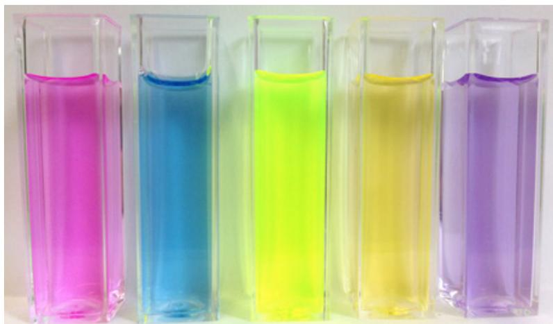
**Abb. 2** Bild einer wässrigen Suspension aus ionenselektiven Nanosphären, die verschiedene Chromoionophore enthalten
