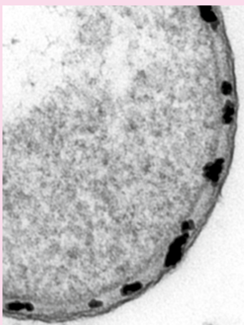
Abb. 1 Palladium-Nanopartikel im Periplasma von Gram-negativen Bakterien
