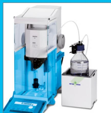
Waage XP205 **kombiniert mit beiden Dosiermodulen Q2 und QLB** für Pulver und flüssige Substanzen
