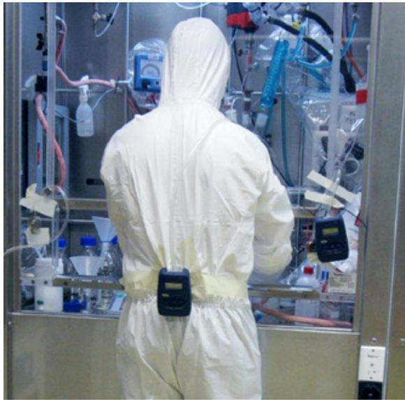
Abb. 2 Expositionsmessung bei Ausführung einer Tätigkeit – links und rechts sind die stationären Messköpfe zu sehen
